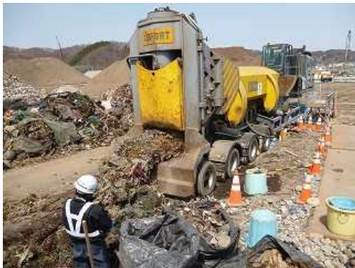
ギロチン式裁断機を用いた裁断例 岩手県宮古地区
