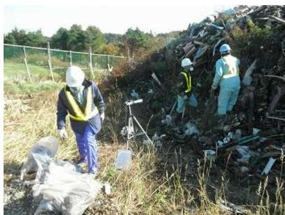
放射性物質濃度測定用試料の採取 岩手県田野畑村浜岩泉地区
