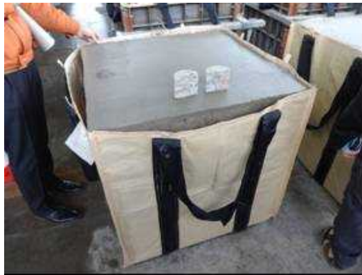
宮城県亘理処理区の不燃残さ・ダスト等を活用した成型材（アップサイクルブロック）
