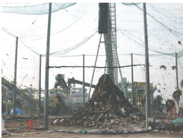
⑨ 選別後の可燃物：その後、仮設焼却炉等により焼却処理対象(石巻ブロック) 飛散防止のためネットで囲っている。
