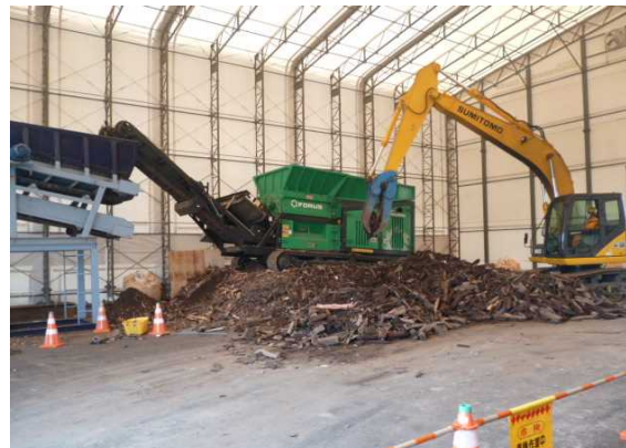
木くず破碎機による破碎 宮城県宮城東部ブロック
