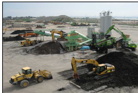
回転式破碎混合（ツイスター）施設 宮城県石巻ブロック
