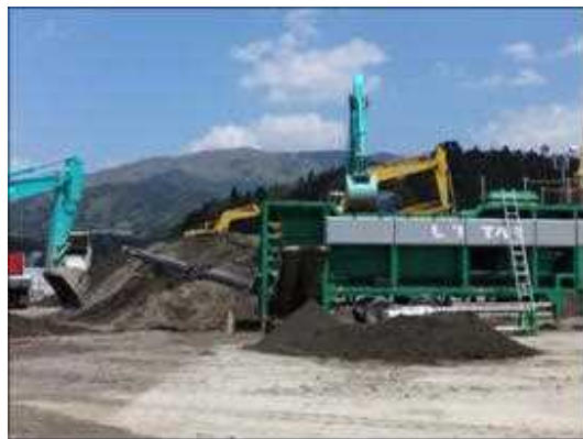
乾式分級：重機により分級機に投入 岩手県陸前高田市(以下同じ)
