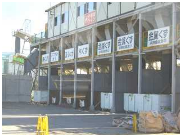
⑧ 手選別後の選別物(石巻ブロック) 手選別コンベヤ(写真上部)で選別されたものが下部スペースに集められ搬送される。
