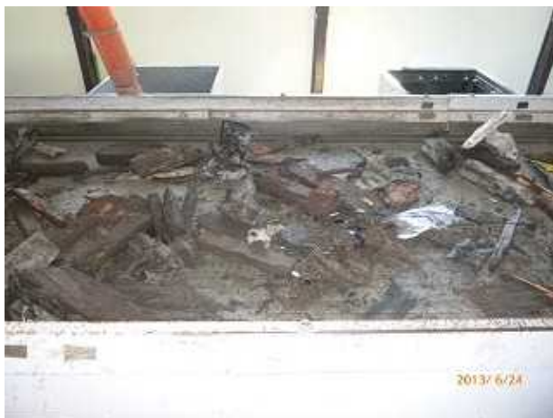
⑦ 手選別コンベヤ上の選別対象廃棄物の状況 (石巻ブロック)
