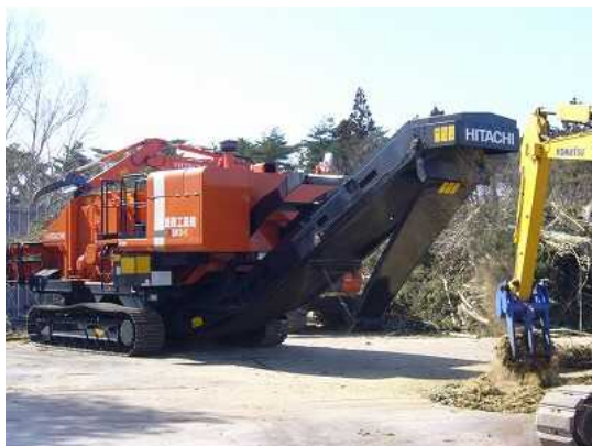
移動式木くず破碎機による破碎 福島県広野町
