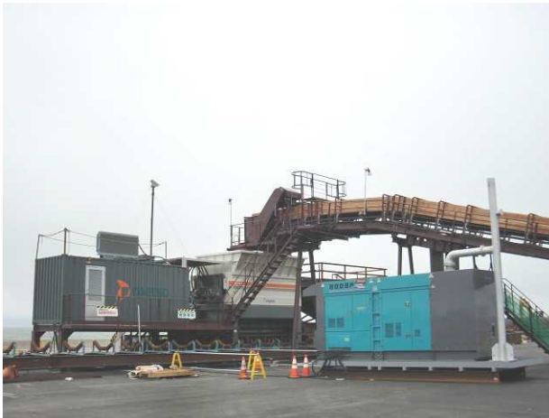
③ 一次破碎：粗破碎機による破碎 (石巻ブロック)
