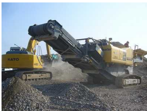
移動式破碎機による破碎(福島県広野町)
