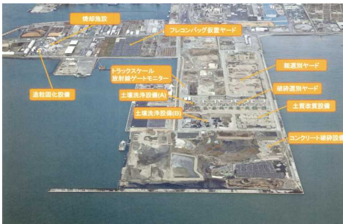
図 3.2.6 二次仮置場施設配置（宮城県石巻ブロック：敷地面積 74ha）
