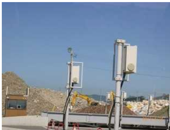
搬出用計量機での自動空間線量率測定装置 石巻ブロックの例
