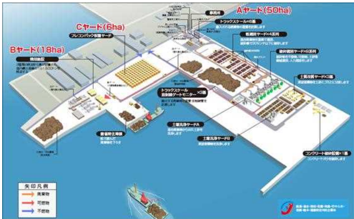
図 3.2.5 二次仮置場施設配置図例（大規模）（宮城県石巻ブロック：敷地面積 74ha）
