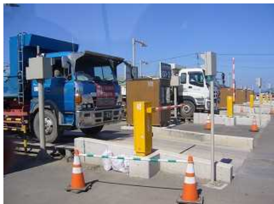
計量機による搬入災害廃棄物等の計量 宮城県石巻ブロックの例
