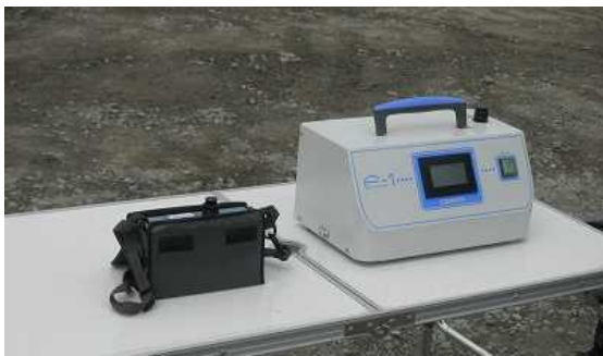
アスベスト測定 岩手県宮古市藤原埠頭二次仮置場
