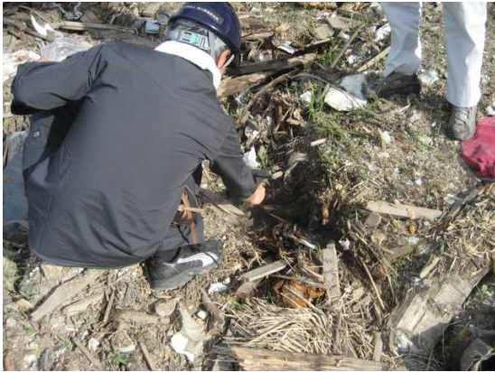
環境省 県内支援チーム、(独)国立環境研究所による巡回点検時の災害廃棄物の温度計測
