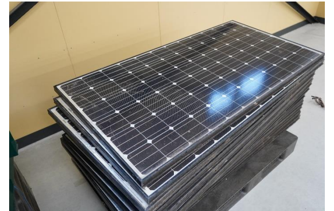
発電を防ぐため、ガラス面を下向きに積む（写真は悪い例）
