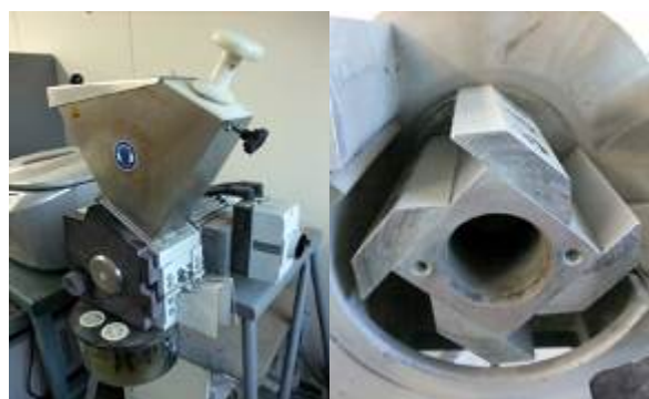
図 4-6-3 カッティングミルの外観と粉砕室
