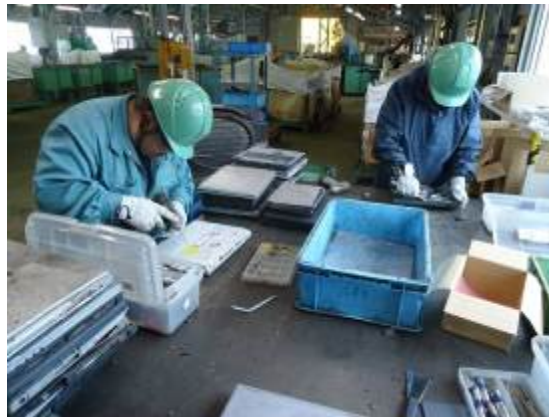
図 4-3-14 ノートパソコンの手解体の様子
