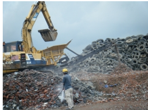
小塚原地区仮置場(散水による飛散防止)
