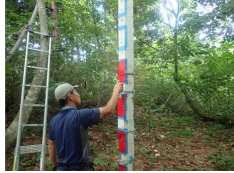
写真1 インターバル撮影の計測スケールとして最深積雪深計を着色(B-7)
