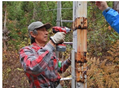
写真1 最深積雪深計の針金追加（秋B-4）
